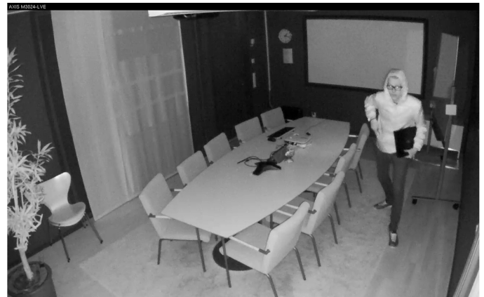
Die obigen Bilder einer AXIS M3024-LVE zeigen dieselbe Szene eines Mannes mit einer kleinen Taschenlampe in einem dunklen Raum. Hier wird der Unterschied deutlich, der durch eine Infrarotbeleuchtung für die Überwachung im Dunkeln erzielt wird. Für das Bild links wurde keine IR-Beleuchtung verwendet. Für das Bild rechts wurde das Licht der in die Kamera eingebauten IR-LEDs verwendet. Infrarotlicht ist für das menschliche Auge unsichtbar, für die Kamera jedoch sichtbar.
